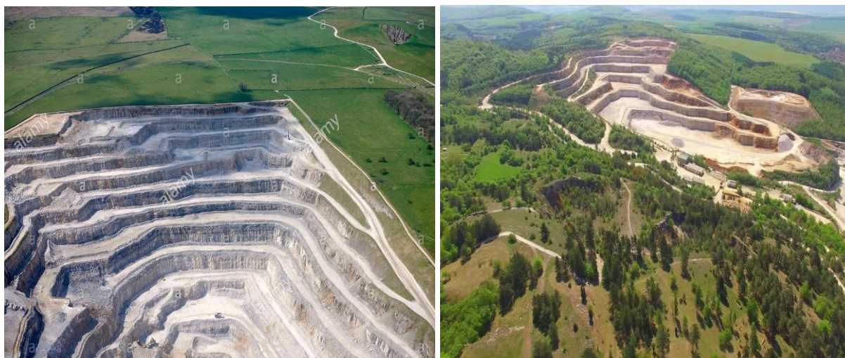
Figura 2. Shfrytëzim i karrierave, duke u nisur nga perimetri i jashtëm dhe duke zbritur në nivelet e mëposhtme deri në nivelet e shfrytëzueshme të mineralit
