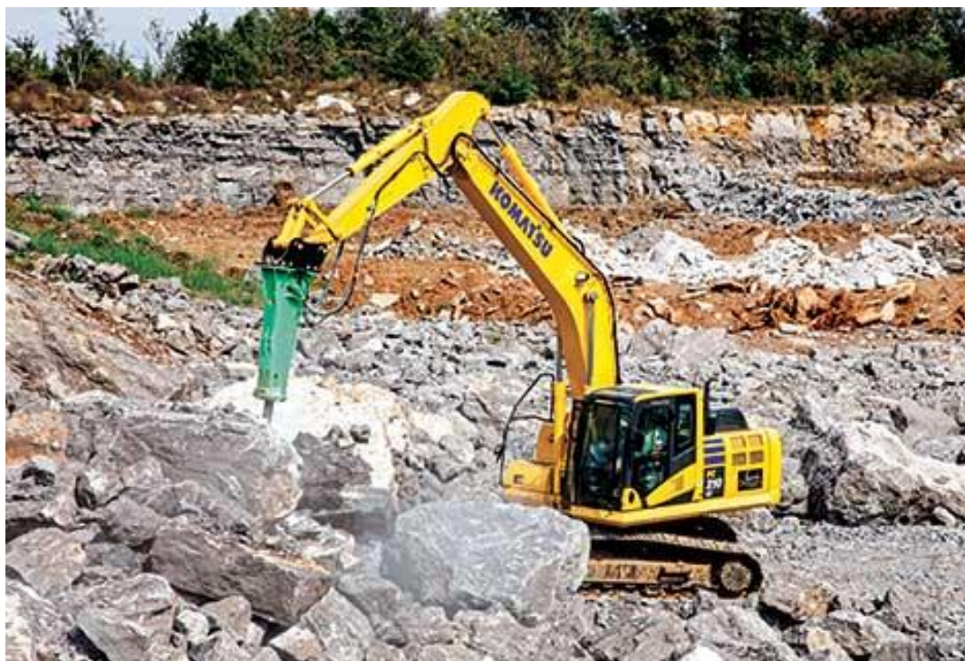
Figura 7. Thyerësi hidraulik i gurit
