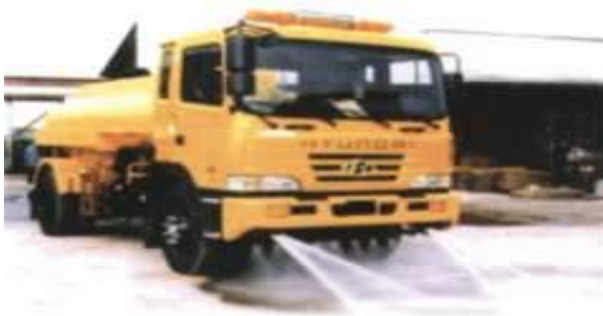
Figura 9. Pajisje për reduktimin e pluhurit të vendosura pranë burimit ku emetohen pluhurat
